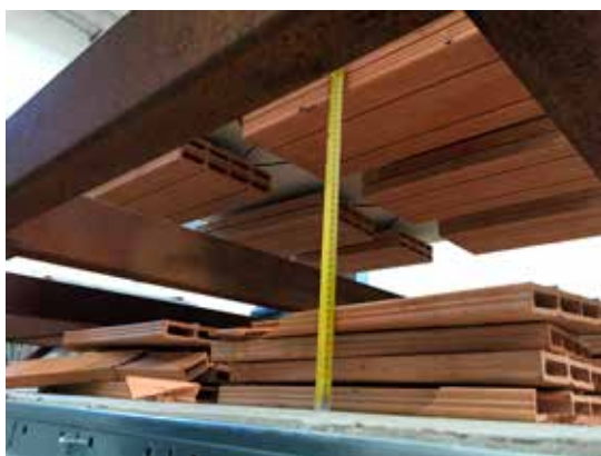
Il campione dopo l'impatto con il controsoffitto e il termine della prova
