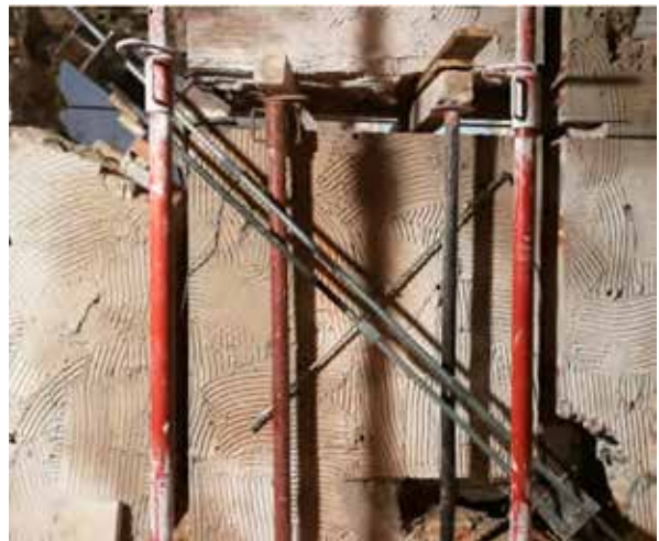
Prove diagonali in situ in aggregato centro storico a L'Aquila di murature rinforzate con rete preformata RG66 NET BA, connettori RG FIX 10 e malta Limecrete M15
